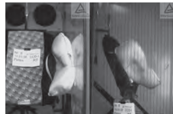
.....und den Seitenairbag nicht in seiner Entfaltung hindert. Er kann sich voll entfalten.
